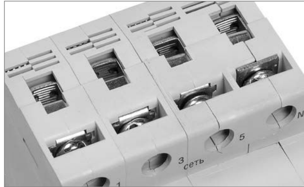
Возможность одновременного присоединения шиной FORK и гибким проводником для распределения питания цепи через верхние зажимы, а также возможность соединения шиной PIN.
